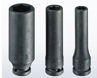
Насадки, магнитные, шестигранные, привод 1/4", подходит для держателя по DIN 3126-F 6,3 / ISO 1173
